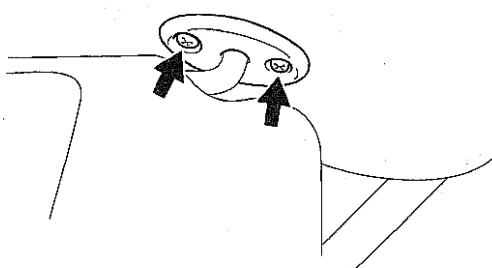
2. 拆下右遮阳板总成；
