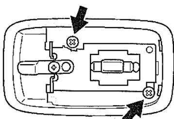
5. 拆下安全拉手分总成
